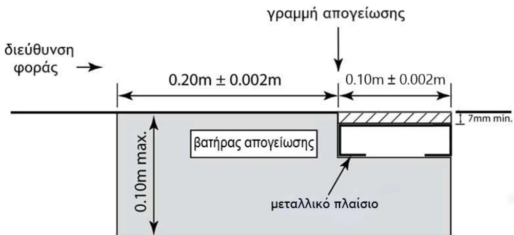
**Σχήμα (α1) TK29 - Βατήρας απογείωσης και πλαίσιο ένδειξης από πλαστελίνη**
