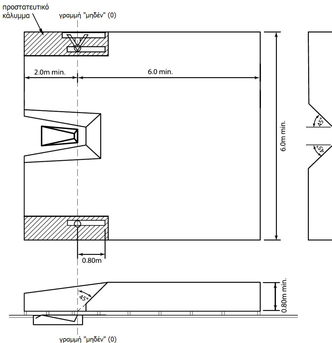
**Σχήμα (γ) TK28 (Άρθρο 183): Στρώμα προσγείωσης Επί Κοντώ (κάτωψη και πλάγια όψη)**
