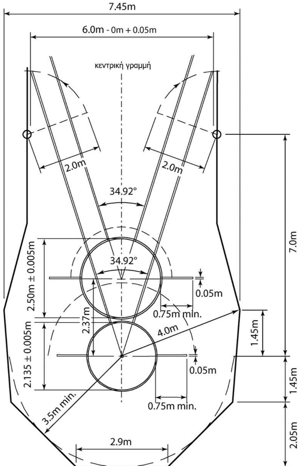
**Σχήμα (γ) ΤΚ37 - Κλωβός για Σφυροβολία και Δισκοβολία με ξεχωριστές βαλβίδες**
