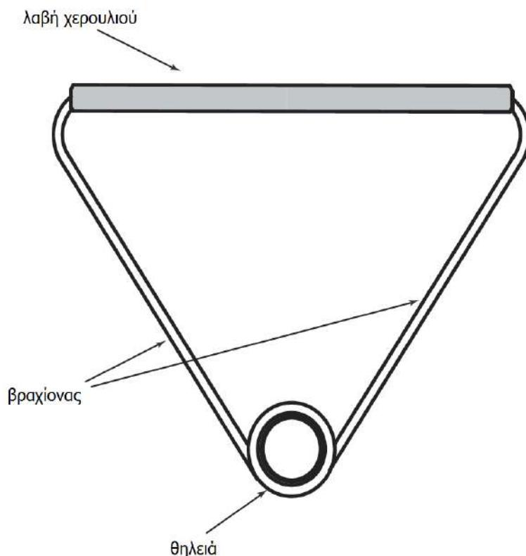
**Σχήμα (β) ΤΚ36 - Γενική μορφή χερουλιού σφύρας**
