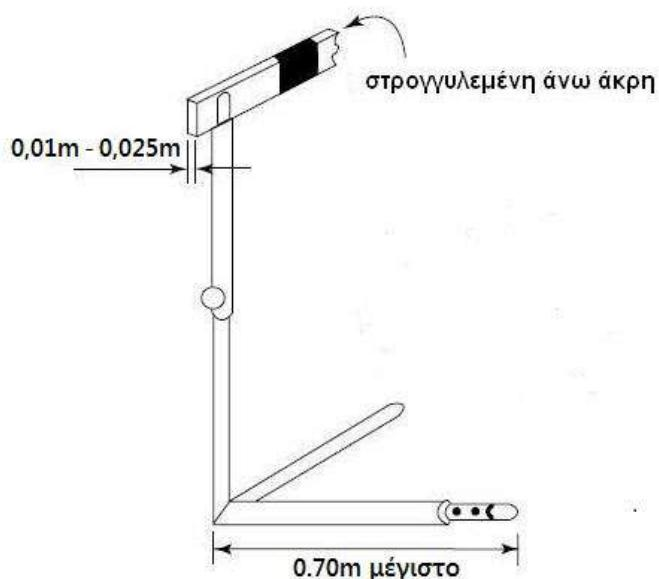
**Σχήμα ΤΚ22 (Άρθρο 168) - Παράδειγμα εμποδίου**
