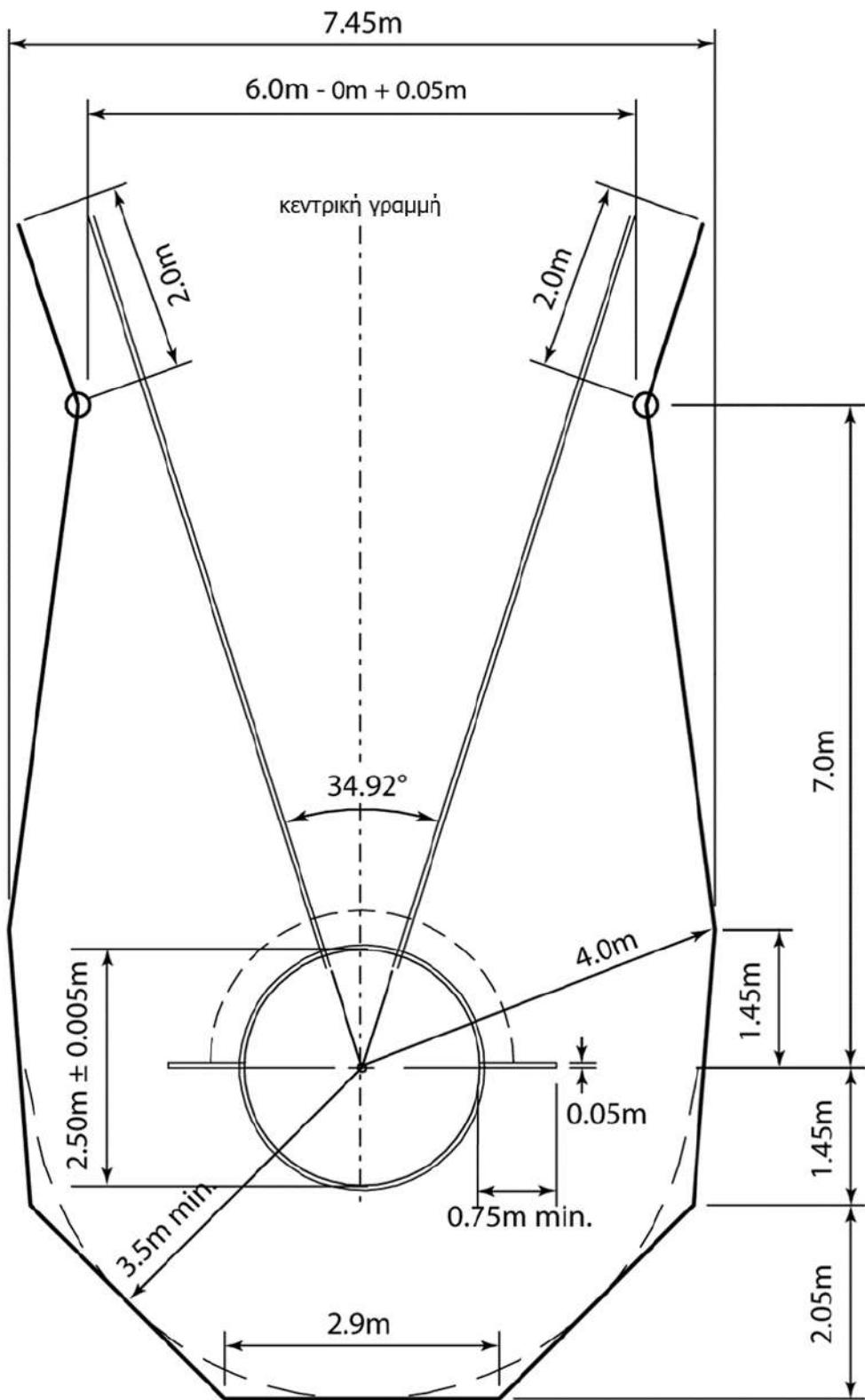
**Σχήμα (β) ΤΚ37 - Κλωβός για Σφυροβολία και Δισκοβολία με ομόκεντρες βαλβίδες
