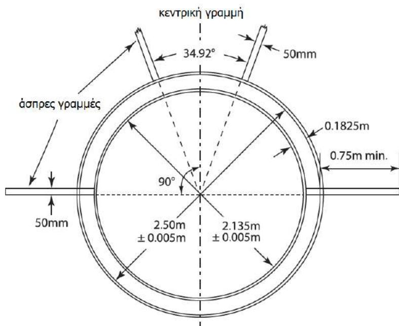
**Σχήμα (δ) ΤΚ32 - Σχεδίαση ομόκεντρων κύκλων για τη βαλβίδα Δισκοβολίας και Σφυροβολίας**
