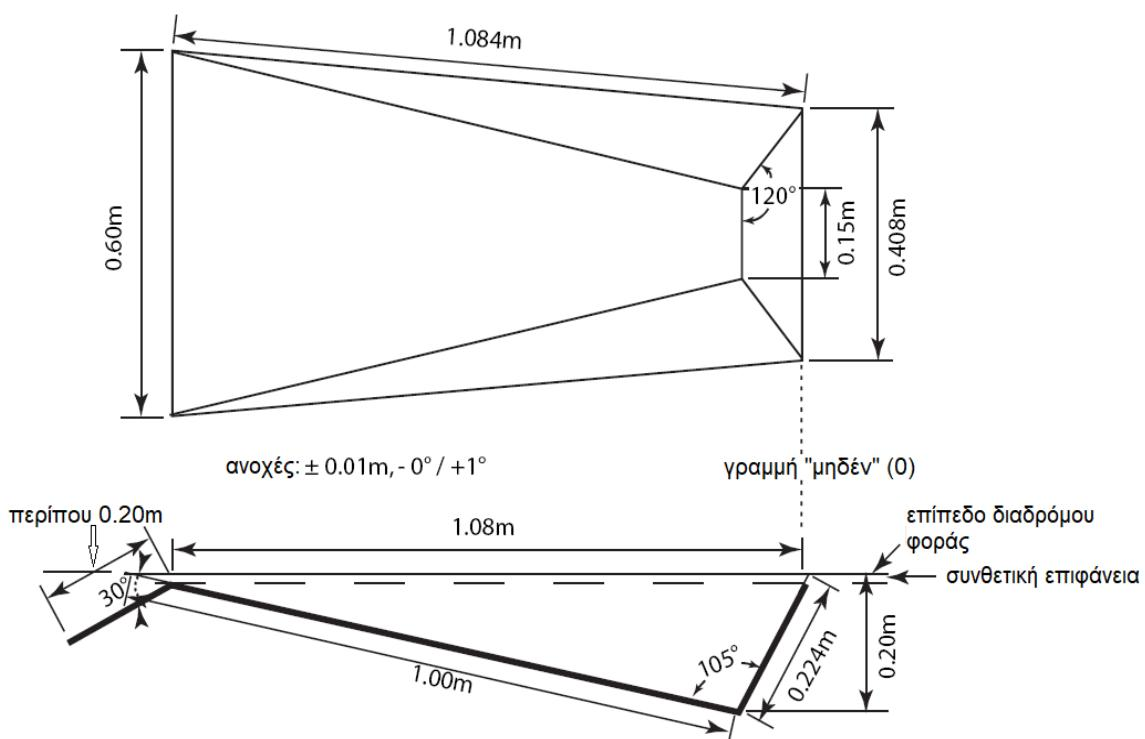
**Σχήμα (α) ΤΚ28 (Άρθρο 183) - Βαλβίδα Επί Κοντώ (κάτοψη και πλάγια όψη)**
